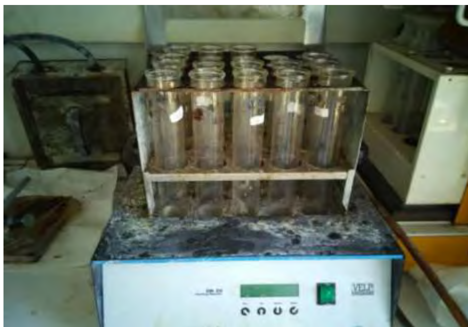
Εικόνα 5. Εκτίμηση των ολικών συγκεντρώσεων ιχνοστοιχείων με βασιλικό νερό: στάδιο πέψης των δειγμάτων.
