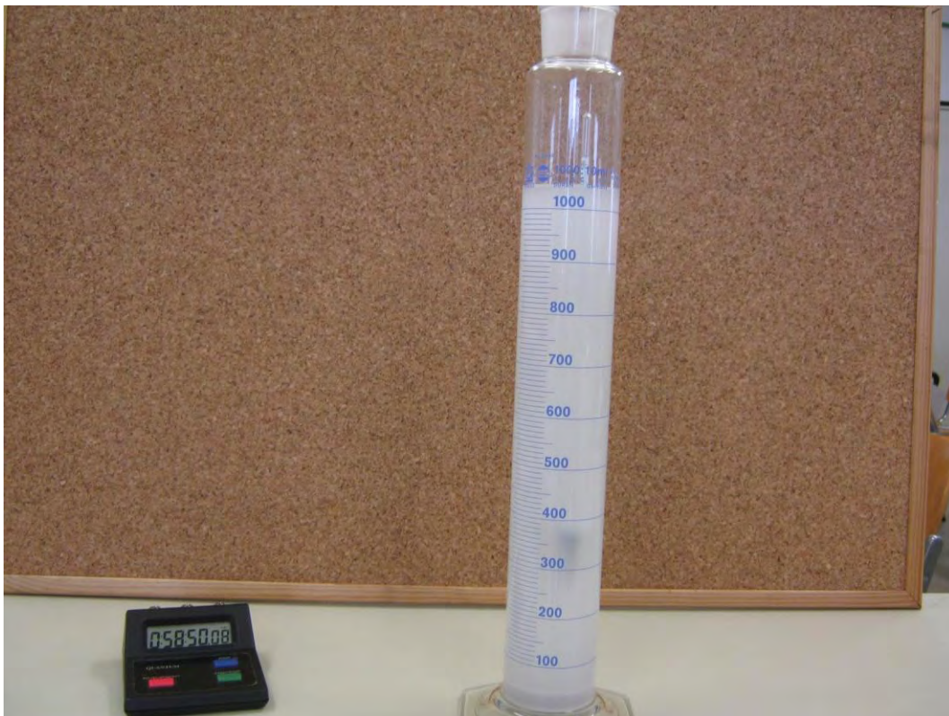
Σχήμα 3.21: Διαδικασία αραιομέτρου κατά την καθίζηση
