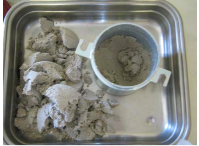
Σχήμα 3.36: Συλλογή του συμπυκνωμένου εδάφους για ξήρανση
