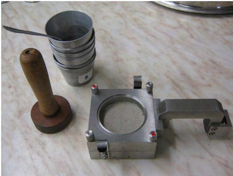
Σχήμα 3.5: Μόρφωση δοκιμίου στο κιβώτιο συμπίκνωσης
