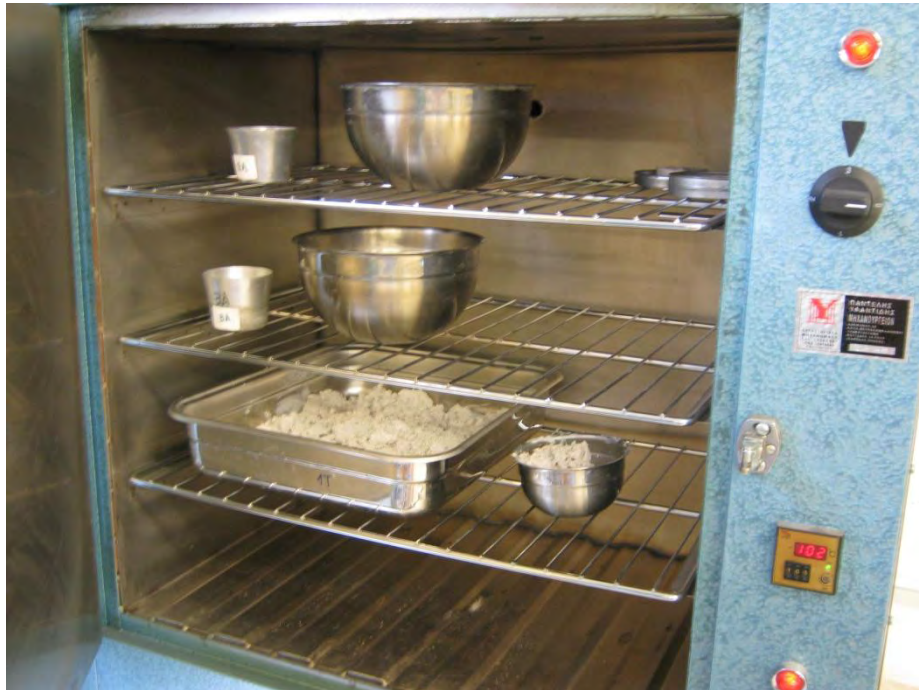
Σχήμα 3.37: Ξήρανση σε κλίβανο 105°C
