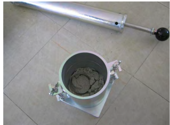
Σχήμα 3.33: Χαλαρό έδαφος στην επιφάνεια μετά τη συμπύκνωση
