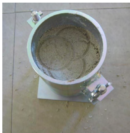
Σχήμα 3.34: Μετά τη συμπύκνωση και της 3 ης στρώσης
