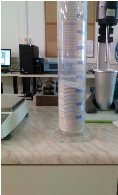
Σχήμα 3.41: Προσδιορισμός όγκου στη δοκιμή ελάχιστης πυκνότητας
