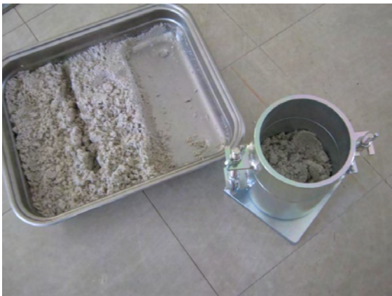
Σχήμα 3.32: Συμπύκνωση πρώτης στρώσης
