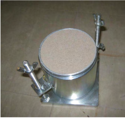
Σχήμα 3.35: Οριζοντίωση της συμπυκνωμένης ποσότητας
