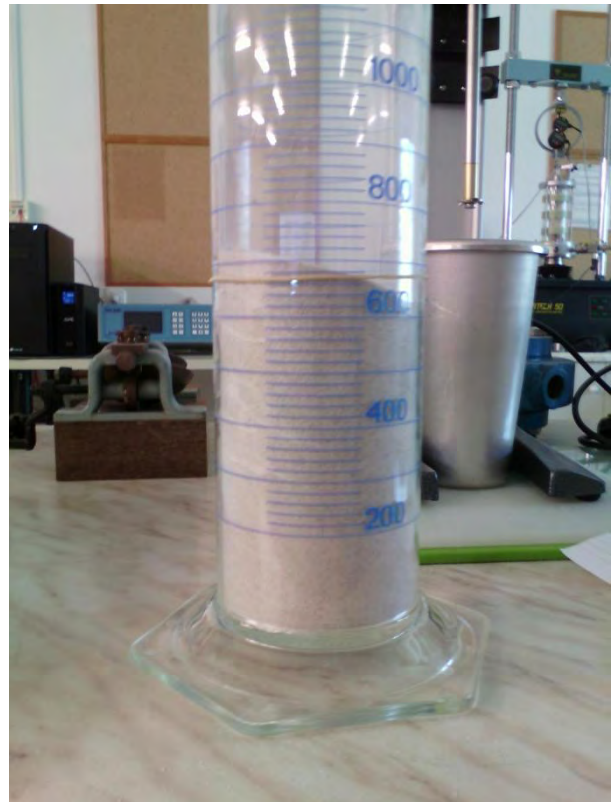
Σχήμα 3.41: Προσδιορισμός όγκου στη δοκιμή ελάχιστης πυκνότητας
