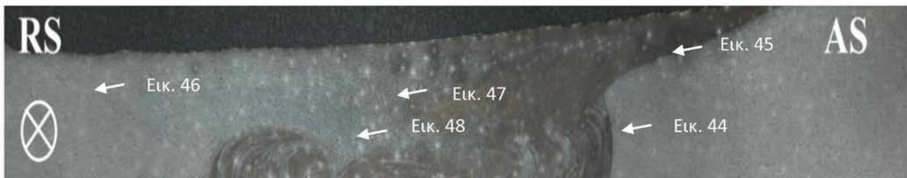
Εικόνα 43: Μακροδομή της συγκόλλησης-1. Σημειώνονται το AS, RS καθώς και η φορά τη συγκόλλησης
