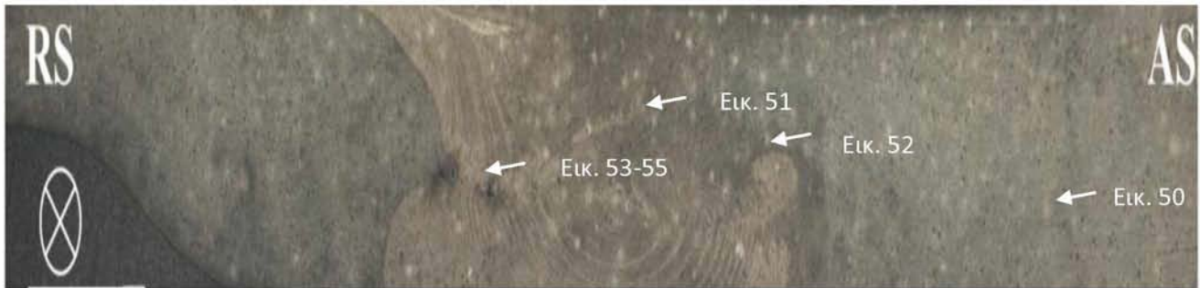
Εικόνα 49: Μακροδομή της συγκόλλησης-2. Σημειώνονται το AS, RS καθώς και η φορά τη συγκόλλησης
