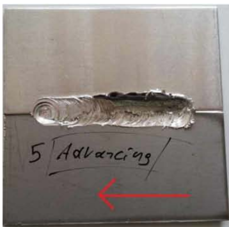
Εικόνα 28: Συγκόλληση Al - Mg (Mg advancing). Το βέλος δείχνει την διεύθυνση της συγκόλλησης.
