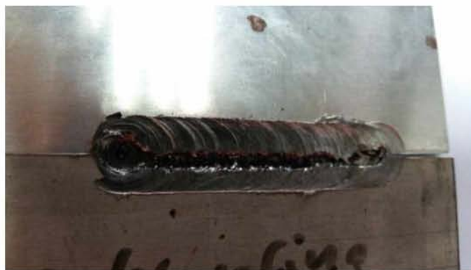
Εικόνα 7: Σφάλμα τύπου tunnel
