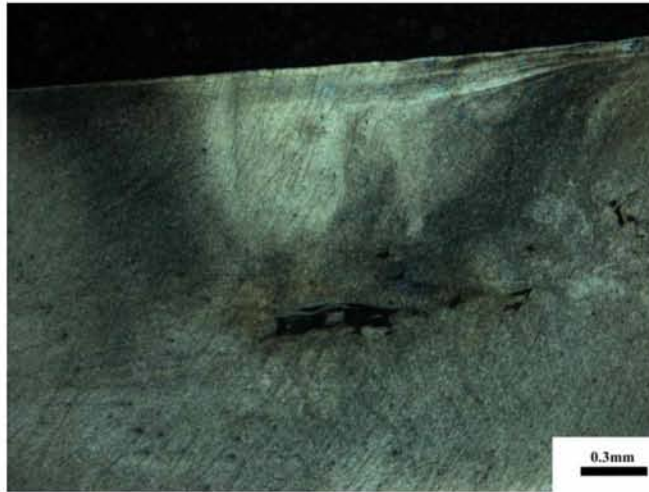
Εικόνα 72: Πορώδες στο NZ της συγκόλλησης (50x)
