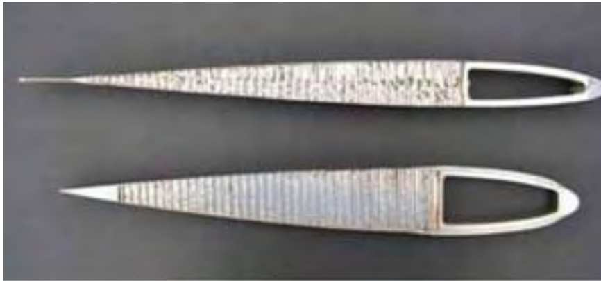
Σχήμα 2.10 Κυψελοειδής δομή σε μεταλλικά πτερύγια
