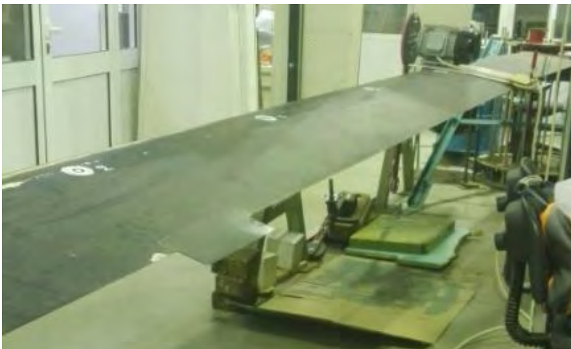
Σχήμα 3.2 Φωτογραφίες από την εργαστηριακή διάταξη της πτέρυγας- Το μοτέρ του διεγέρτη και η κατασκευή της πάκτωσης στο βάθος.
