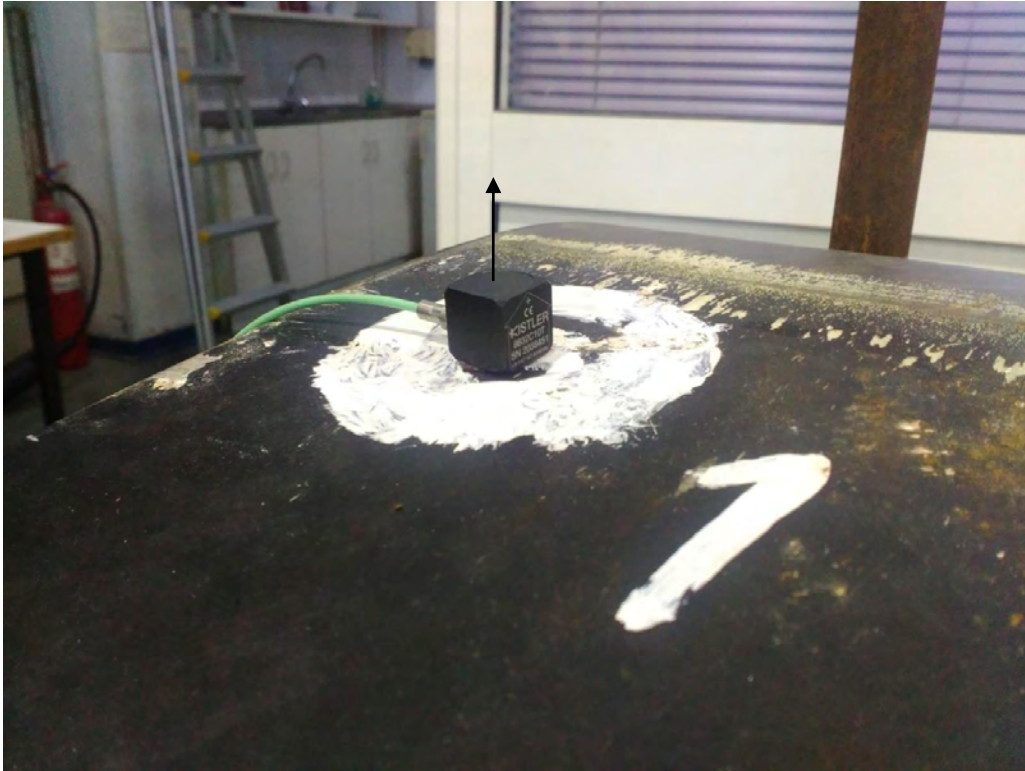
Σχήμα 3.5 Επιταχυνσιόμετρο KISTLER 8632C10T με το βέλος να δείχνει τη διεύθυνση μέτρησης
