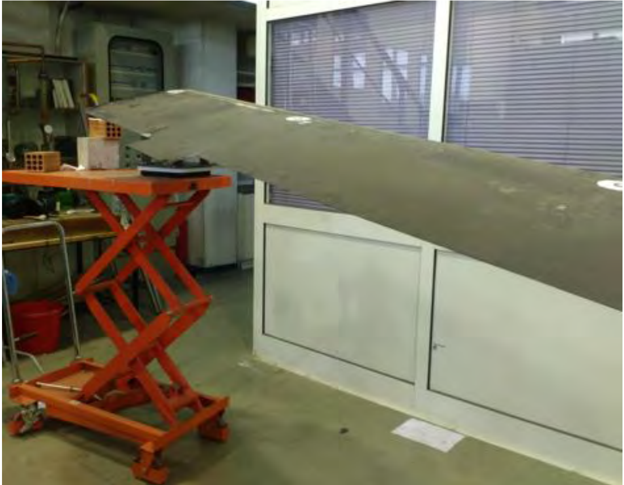
Σχήμα 3.13 Ο τρόπος άσκησης στατικού σημειακού φορτίου με φορά προς τα πάνω μέσω ανυψωτικού μηχανισμού.
