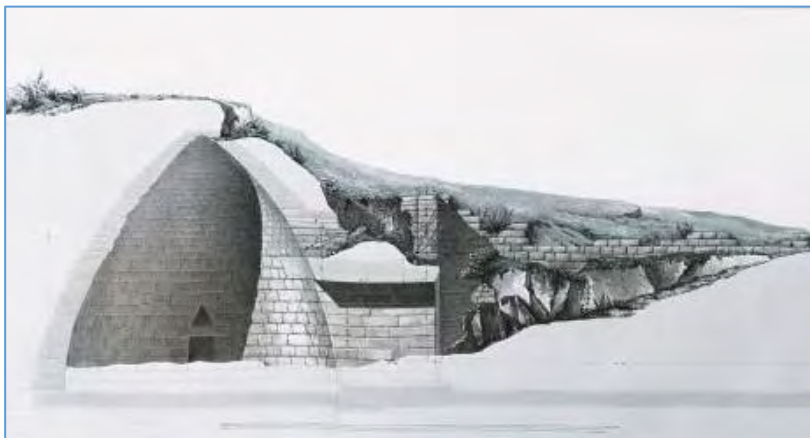
Εικόνα 1. Τομή καθ' ύψος του Θολωτού τάφου των Μυκηνών. (Πηγή: http://el.travelogues.gr/item.php?view=57855 – 17/7/2016)
