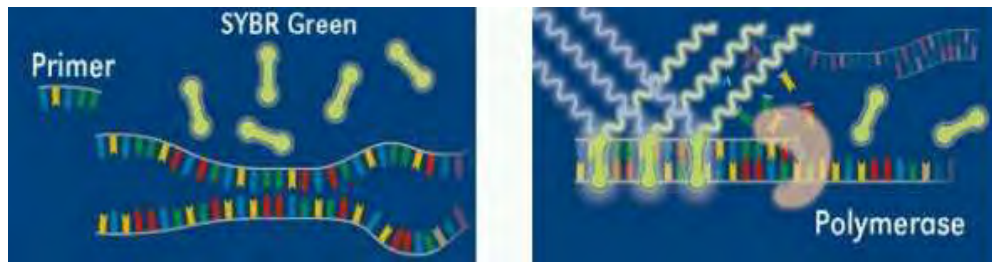
Εικόνα 10. Τρόπος λειτουργίας της μεθόδου Real Time PCR με τη χρήση της χρωστικής SYBR Green I (Lee et al, 2009).
