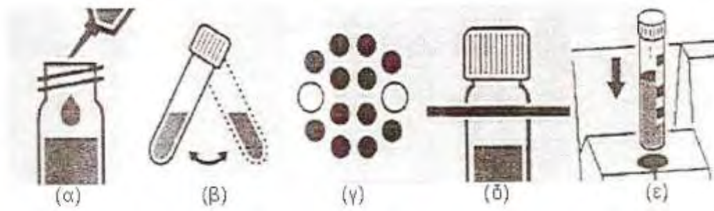
Εικόνα 7. Στάδια της διαδικασίας προετοιμασίας για την μέτρηση του COD
