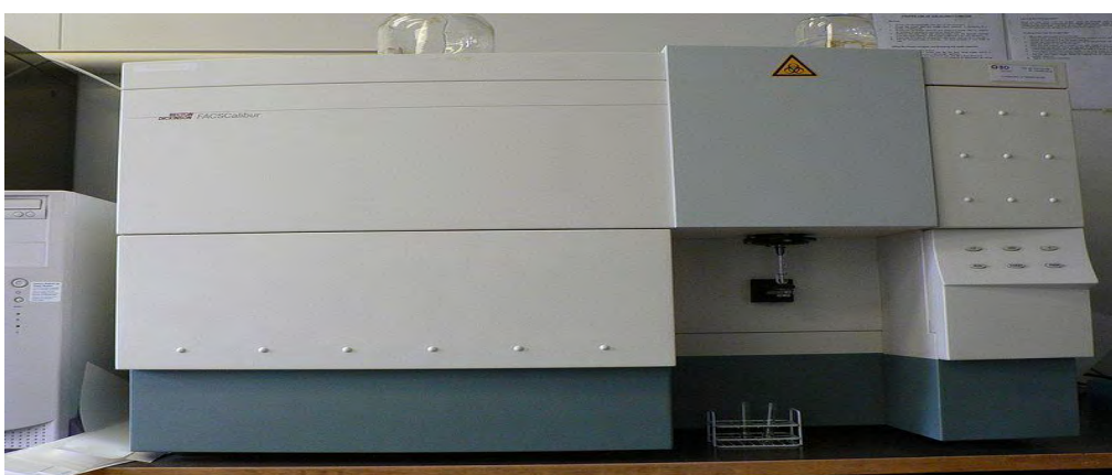
Εικόνα 20: Το μηχάνημα της κυτταρομετρίας ροής από την Becton-Dickinson
