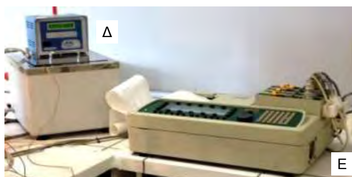
Εικόνα 15. Α. πειραματική διάταξη μελέτης συσταλτικότητας λείου μυ τραχείας κονίκλου, Β. λουτρό διαπότισης, Γ. μηχανομετατροπείς Grass FT03C force displacement transducer, Δ. θερμαντήρας νερού, Ε. καταγραφικό 4 ov καναλιών Grass 7400 Physiological Recorder
