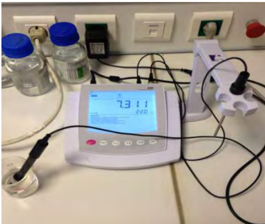
Εικόνα 17. Μέτρηση του pH του διαλύματος διαπότισης (Krebs) – πεχάμετρο Bante 930.
