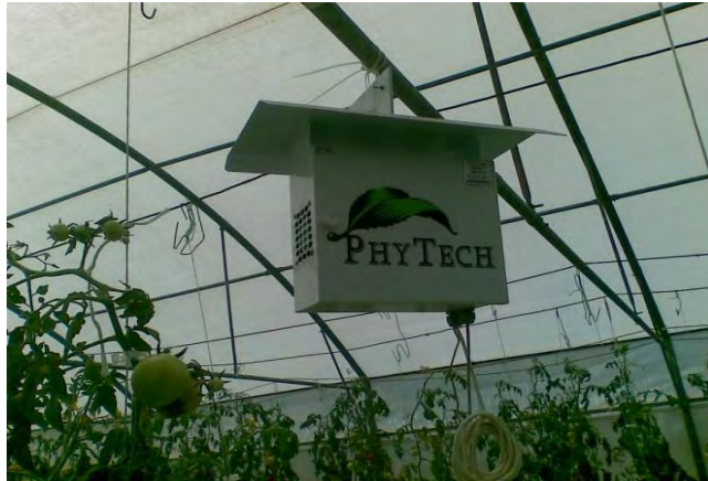
Εικόνα 3.4. Αισθητήρας μέτρησης θερμοκρασίας και Σχετικής υγρασίας αέρα μέσα στο προστατευτικό κάλυμμα.
