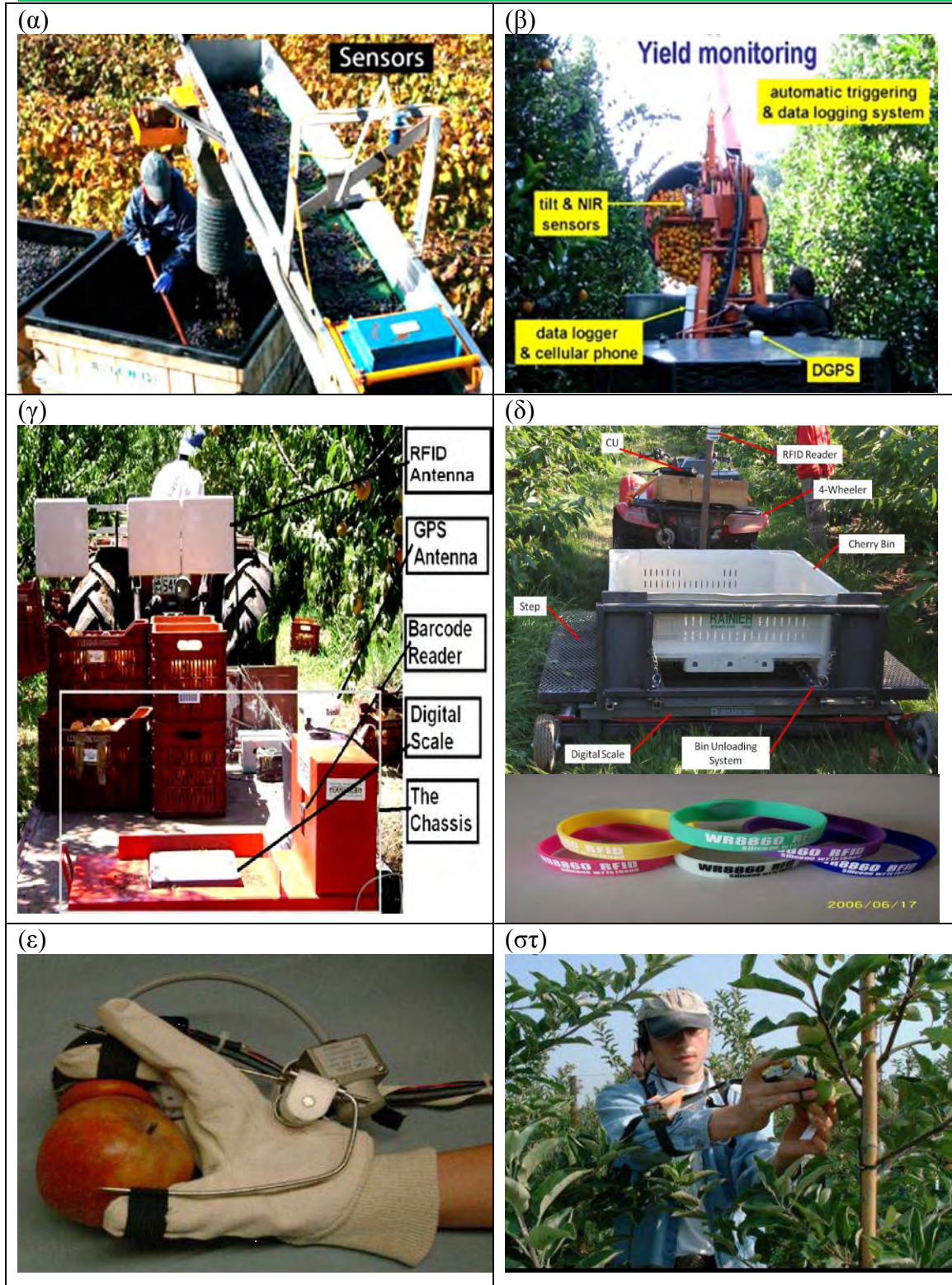
Εικόνα 30: (α) Σύστημα μέτρησης ροής σταφυλιών με εκτίμηση του όγκου τους με τη χρήση υπερήχων (Bates et al., 2014). (β) Εξοπλισμός για τη χαρτογράφηση της παραγωγής πορτοκαλιών στη Φλόριντα, ΗΠΑ (Whitney et al., 1999). (γ) Σύστημα αναγνώρισης, ζύγισης και καταγραφής θέσης για χαρτογράφηση παραγωγής ροδάκινων (Ampatzidis et al., 2009). (δ) Σύστημα μέτρησης απόδοσης εργατών με RFID Tags (Alhanatis et al, 2012). (ε) και (στ) Οπτικοί αναγνώστες καρπών και μετασυλλεκτικών χειρισμών. (Zoynt Em. , 2009).
