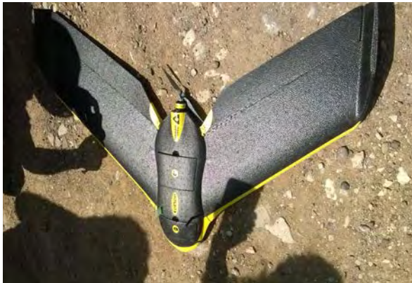
Εικόνα 40: Τύποι Μη επανδρωμένων ιπτάμενων οχημάτων (UAV- Unmanned Aerial Vehicles/ drone) (α) με σταθερά πτερύγια fixed- wing και (β) ελικοφόρο Octacopter
