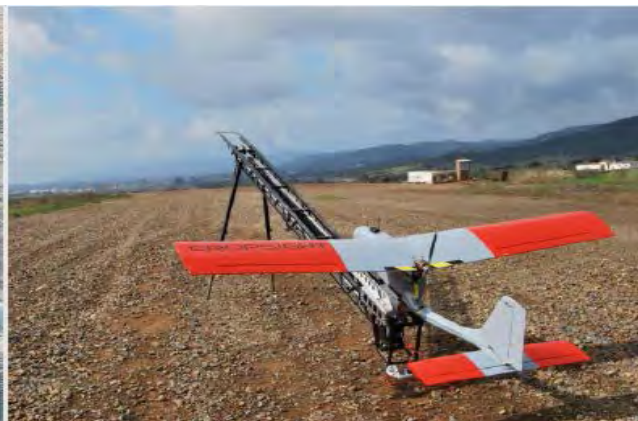
Εικόνα 40: Τύποι Μη επανδρωμένων ιπτάμενων οχημάτων (UAV- Unmanned Aerial Vehicles/ drone) (α) με σταθερά πτερύγια fixed- wing και (β) ελικοφόρο Octacopter
