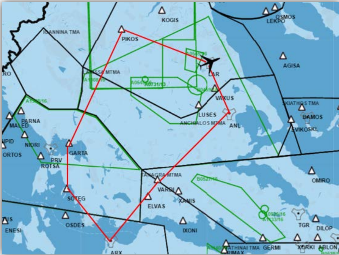
Εικόνα 40. Παράδειγμα IFR διαδρομής πτήσης που επηρεάζεται από δεσμευμένες περιοχές.
