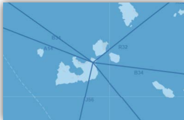
Εικόνα 11. Αναπαράσταση αεροδιαδρόμων χαμηλού ύψους.
