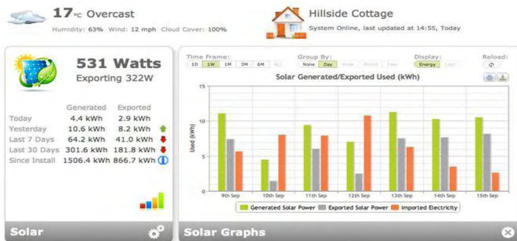
Εικόνα 2. Σύστημα παρακολούθησης και έλεγχου της ηλεκτρικής ενέργειας.
