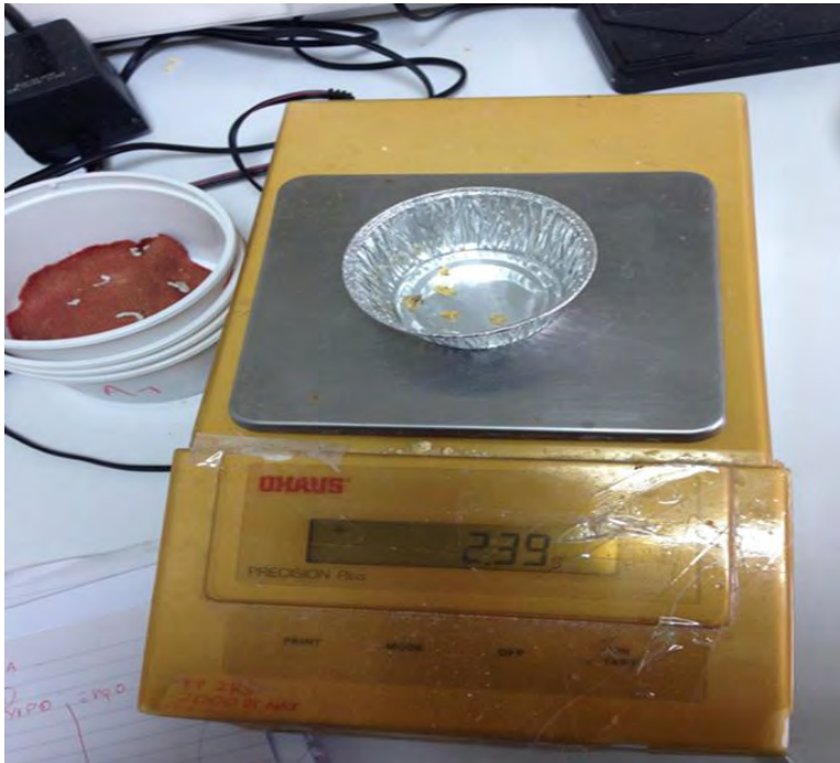
Εικόνα 7. Συλλογή και μέτρηση του βάρους των υγρών περιττωμάτων πριν τοποθετηθούν στον κλίβανο, στους 67 °C (Πηγή: προσωπικό αρχείο)
