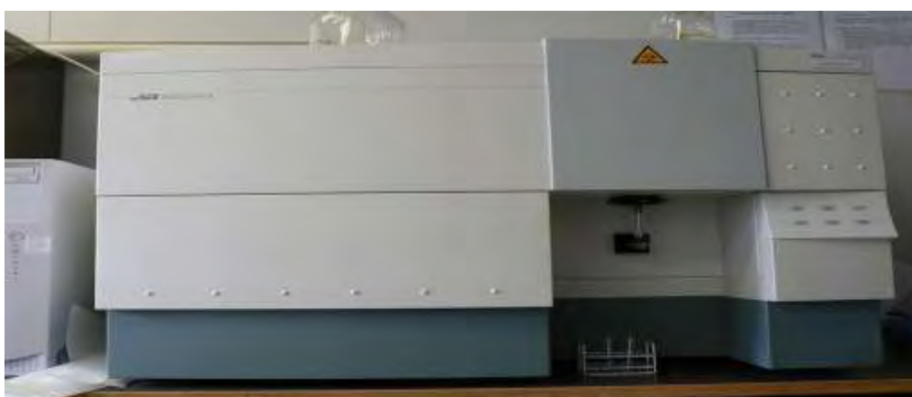
Εικόνα 21: Το μηχάνημα της κυτταρομετρίας ροής από την Becton-Dickinson
