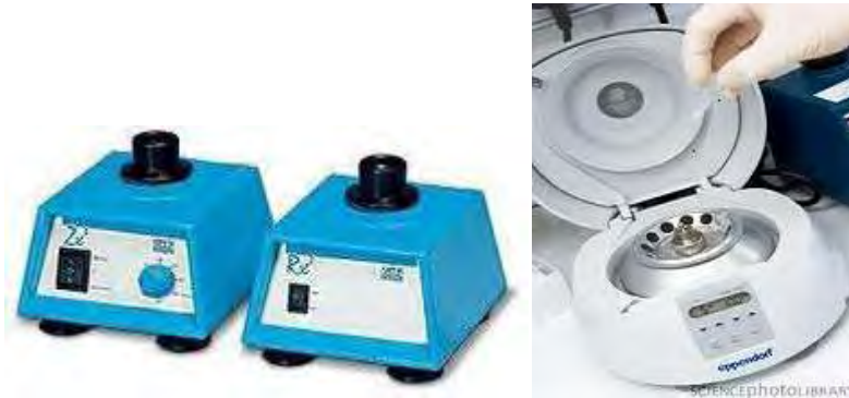
Εικόνα 14: Συσκευές ανάδευσης vortex και στροβιλισμού spin
