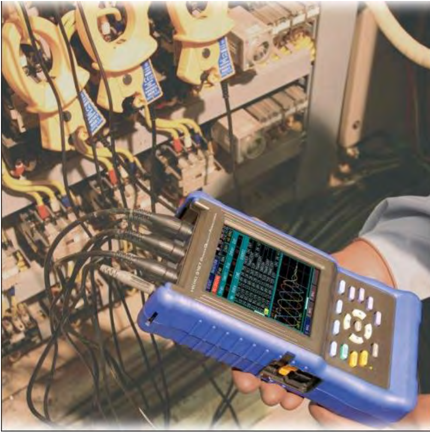
Εικόνα 27 : Το HIOKI 3147 εγκατεστημένο
