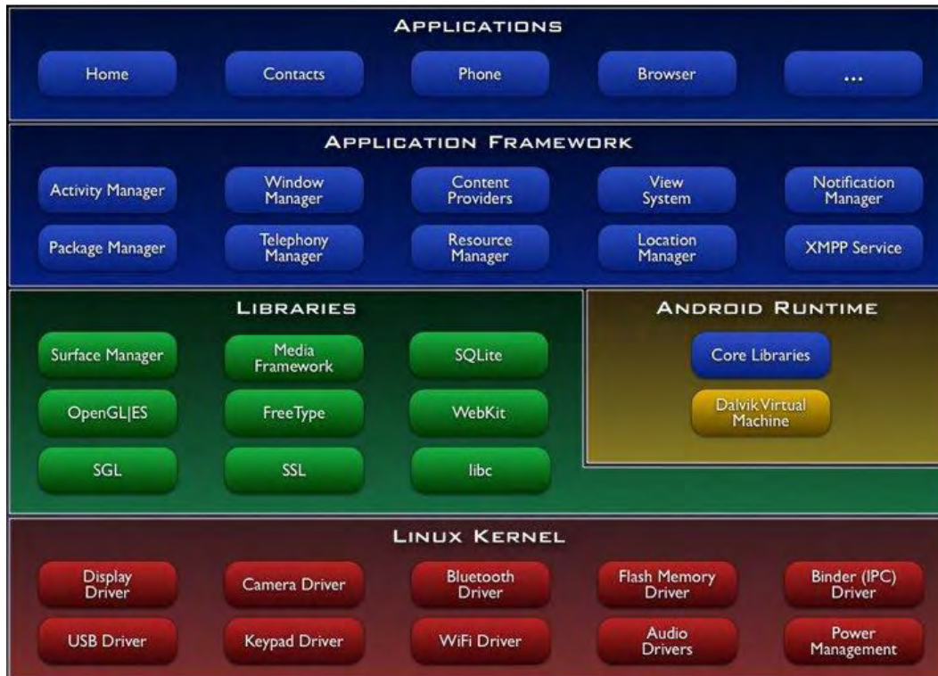
Εικόνα 4.1 Η δομή της αρχιτεκτονικής του λειτουργικού συστήματος Android [9].
