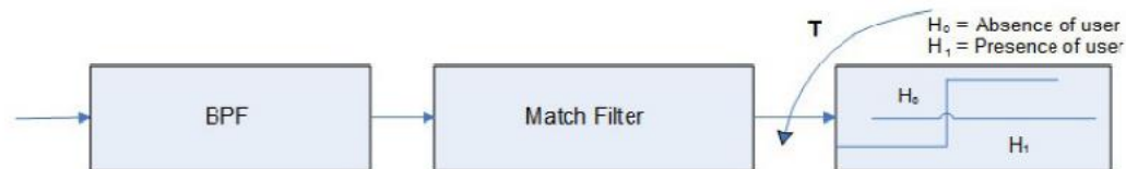
Εικόνα 2.2: Το μπλοκ διάγραμμα του ανιχνευτή προσαρμοσμένου φίλτρου.
