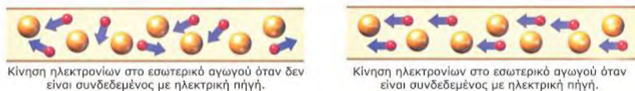
Εικόνα 8: Κίνηση φορτίων σε έναν αγωγό α) χωρίς και β) με την επίδραση ηλεκτρική πηγής (Πηγή: http://karantonigg.blogspot.gr/ )
