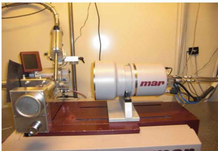
Εικόνα 4.9: Συσκευή κρυσταλλογραφίας ακτίνων X του εργαστηρίου MAX-lab του Lund University (αριστερά) όπου παρουσιάζονται η πηγή ακτίνων X και ο ανιχνευτής (δεξιά)
