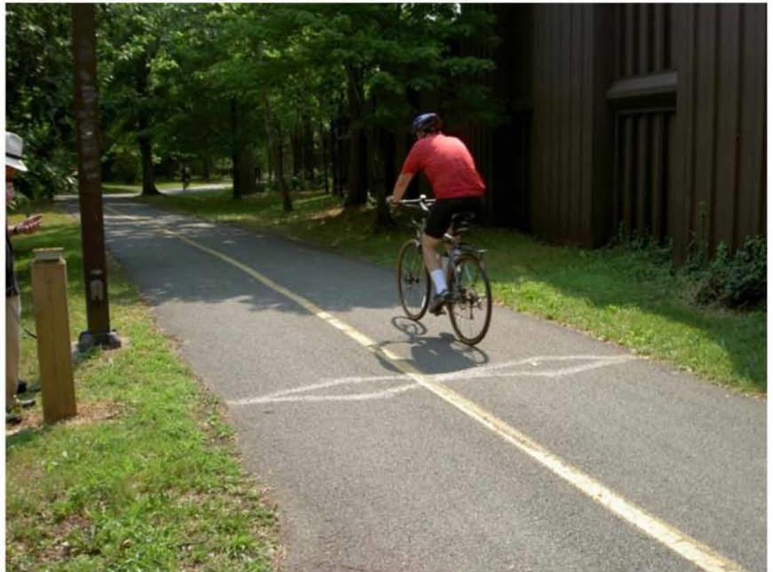
ΣΧΗΜΑ 6 Μόνιμος μετρητής σε μια διαδρομή κοινής χρήσης στο Arlington της Βιρτζίνια, με έναν επαγωγικό βρόγχο μια θηλιά αυτεπαγωγή στο οδόστρωμα και τον υπέρυθρο μετρητή και τη μονάδα επεξεργασίας κρυμμένη σε μια ξύλινη θέση στα αριστερά. (Εικόνα: Krista Nordback, PE, Ph.D. ; χρησιμοποιείται με την άδεια.)
