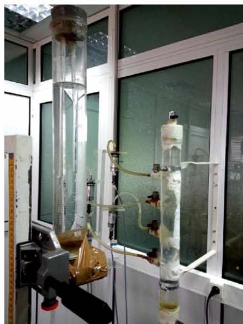
Εικόνα 7. Η συσκευή Mariotte στο πείραμα.
