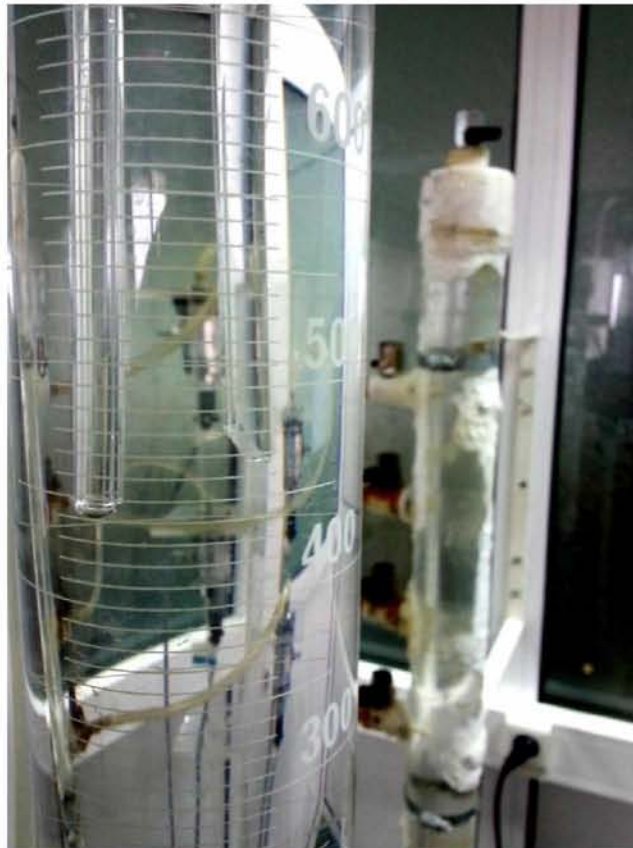
Εικόνα 8. Σημείο ατμοσφαιρικής πίεσης στη συσκευή Mariotte.
