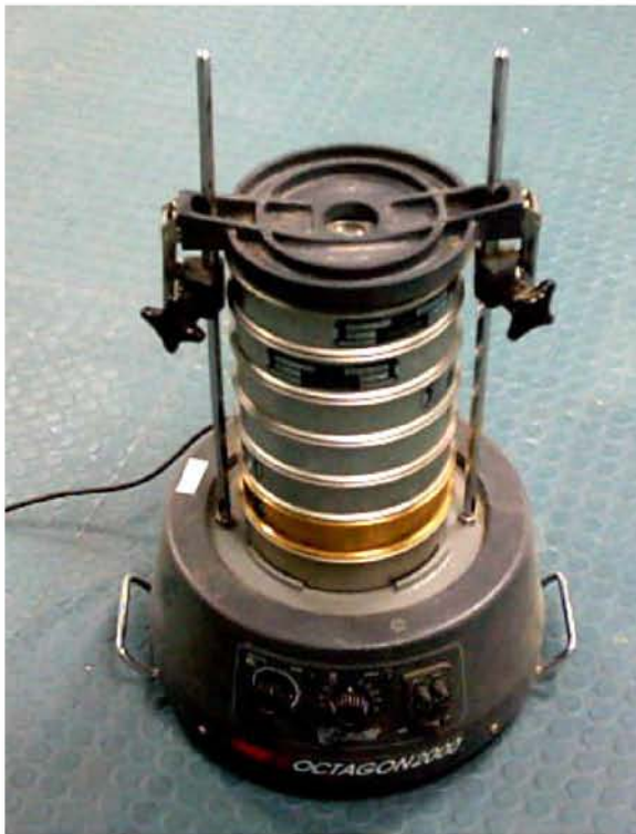
Εικόνες 12 και 13. Συσκευές κοσκινίσματος με έξι κόσκινα διαφορετικών οπών (αριστερά: Εργαστήριο Υδραυλικής Π.Θ., δεξιά: Εργαστήριο Εδαφικών Πόρων Τ.Ε.Ι. Λάρισας).
