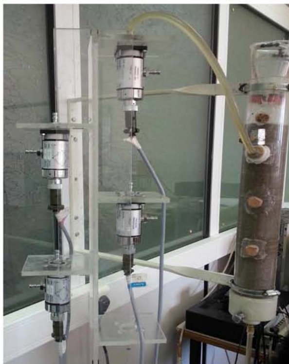
Εικόνα 2. Τασίμετρο συνδεδεμένο με μετατροπέα πίεσης.
