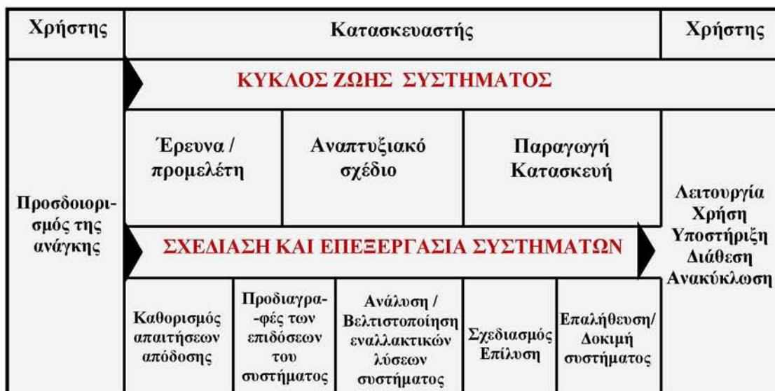
Σχήμα 5: Η σχέση μεταξύ του Κύκλου Ζωής Συστήματος και της Σχεδίασης και Επεξεργασίας Συστημάτων ή “ Systems Engineering ” ( Utne, 2009 ).
