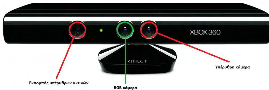
Εικόνα 1: Η Kinect κάμερα και τα συστατικά στοιχεία της.
