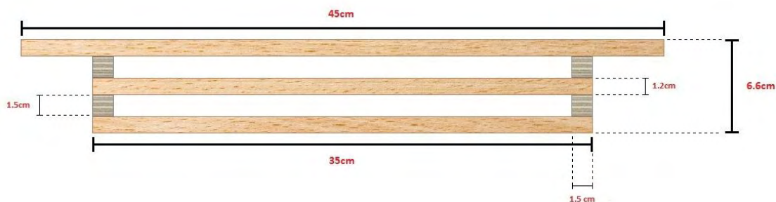
Σχήμα 2: Σχέδιο της ξύλινης κατασκευής της πηγής φωτισμού.
