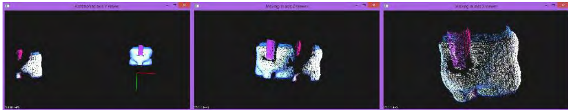
Εικόνα 6: Η περιστροφή του δεύτερου point cloud ως προς τον άξονα Y κατά -90^\circ (αριστερά), η μετατόπιση του δεύτερου point cloud ως προς τον άξονα Z (κέντρο), η ένωση του δεύτερου point cloud με το point cloud του μοντέλου.
