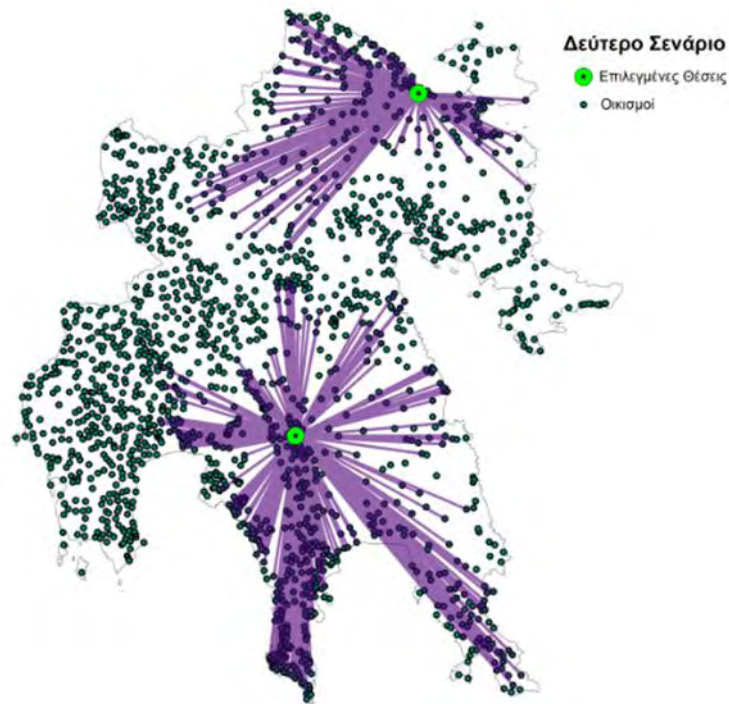
Χάρτης 16: Επιλεγμένες θέσεις χωροθέτησης 1 ου Σεναρίου για εγκαταστάσεις ΟΕΔΑ-ΧΥΤ βάση του αλγόριθμου p-median, Πηγή: Ιδία Επεξεργασία.
