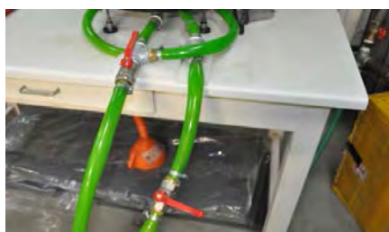
Εικόνα 3.5 Διακλάδωση σωληνώσεων εξόδου του ρευστού από τη βάση του κυλίνδρου.
