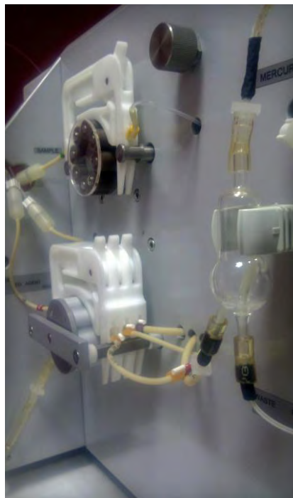
Εικόνα 3.15.: Φασματοφωτόμετρο Ατομικού Φθορισμού Ψυχρού ατμού (CV-AFS) / Κυψελίδα συνεχούς ροής
