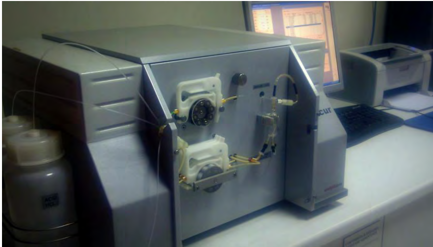
Εικόνα 3.14.: Φασματοφωτόμετρο Ατομικού Φθορισμού Ψυχρού ατμού (CV-AFS)
