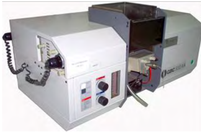
Εικόνα 3.11.: Ατομική Απορρόφηση με φλόγα (FAAS)
