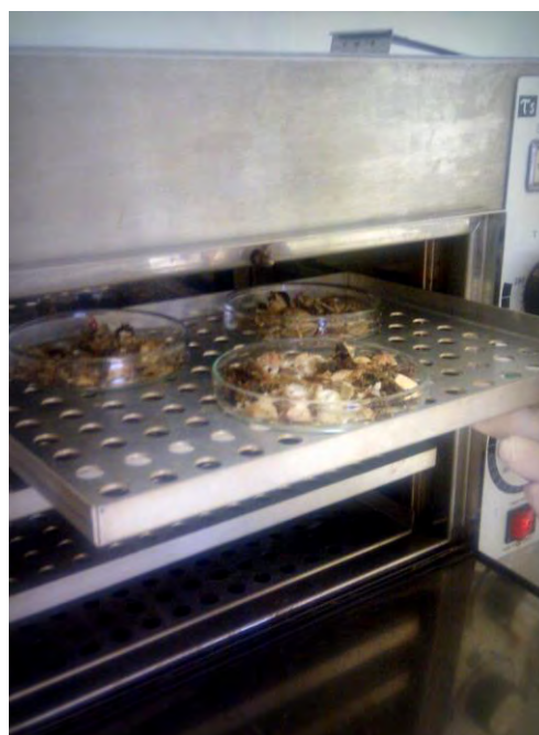
Εικόνα 3.6.: Προετοιμασία δειγμάτων για προσδιορισμό υγρασίας – τοποθέτηση σε φούρνο με αέρα στους 100\pm 2^{\circ}\text{C} .
