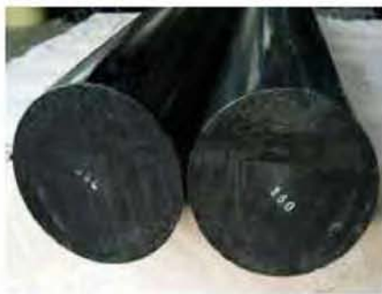
Σχήμα 6.7: α) Τα δοκίμια των πειραμάτων του ενισχυμένου πολυμερούς PA66-GF30, β) Πίνακας με τις διαστάσεις των δοκιμίων ανά κατεργασία.
