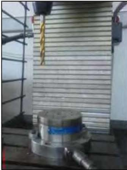
Σχήμα 9.1: α) Διάταξη δρασάνου-δυναμομέτρου β) Κατεργασμένο δοκίμιο και οπές πειραμάτων (οι οπές χωρίς αρίθμηση χρησιμεύουν για την στήριξη του δοκιμίου στο δυναμόμετρο).
