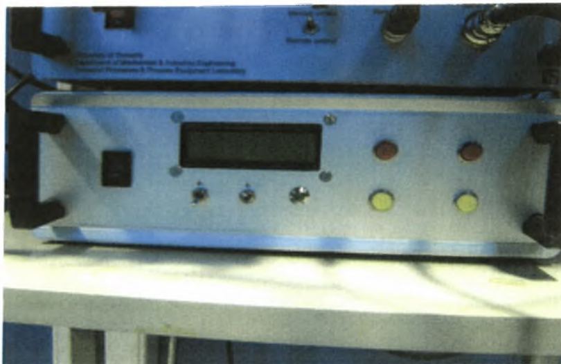
Σχήμα 3.7: Ψηφιακός χρονιστής του συστήματος διαταραχής
