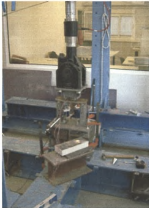
Σχήμα 3.3.1. Ενεργοποιητής φορτίου και πειραματική διάταξη δοκιμής κάμψης τεσσάρων (4) σημείων με επαναλαμβανόμενη φόρτιση.
