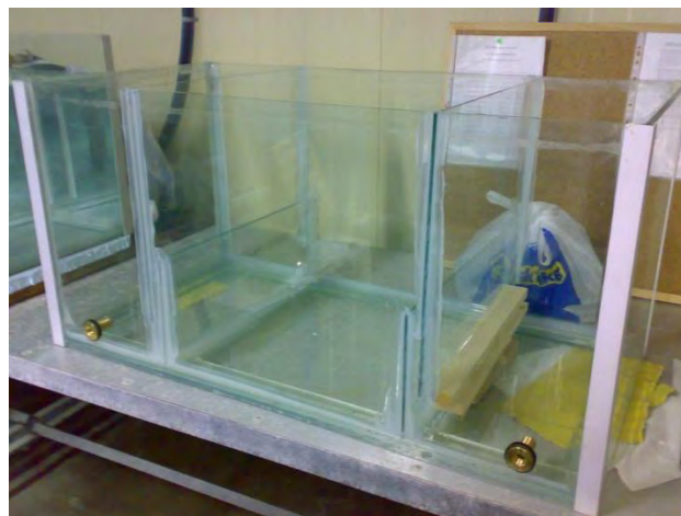
Εικόνα 8: Φίλτρο τύπου 'sub' συνολικού όγκου 265 L (Πηγή: Προσωπικό αρχείο)
