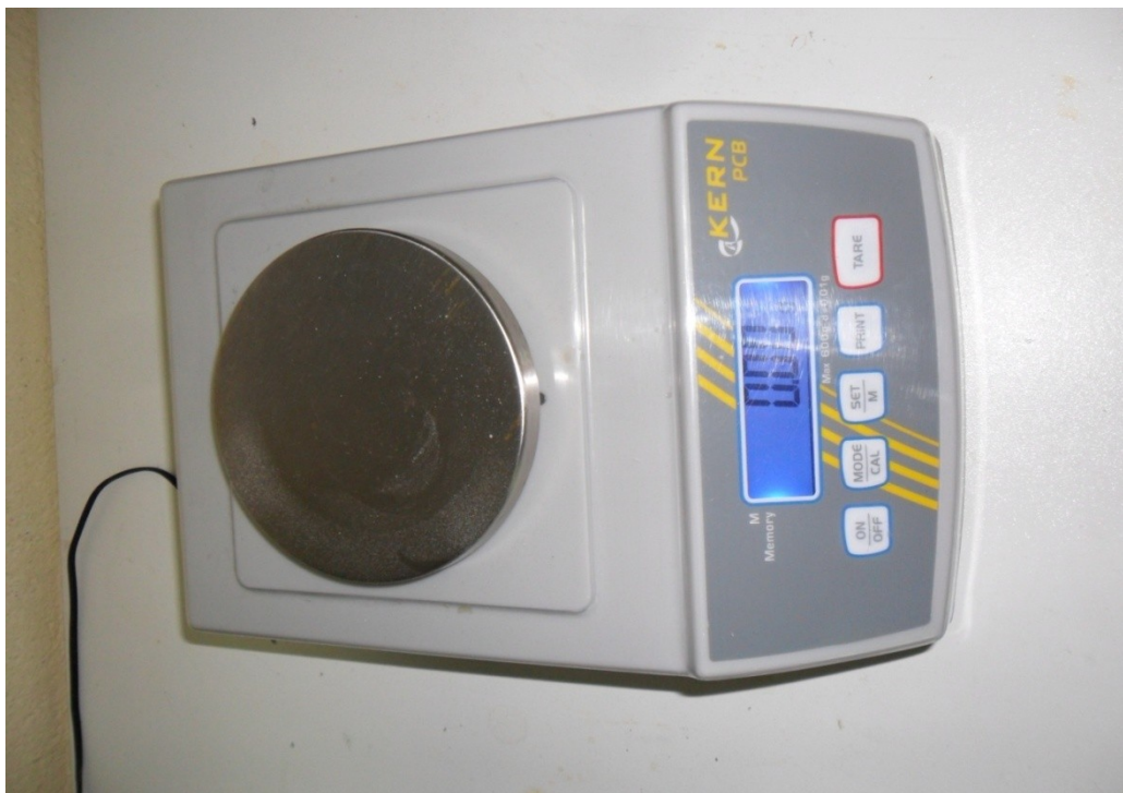
Εικόνα 19. Ψηφιακή φορητή ζυγαριά (KERN PCB) . (φωτο: Παναγιώτης Ν. Μουρούτης)
