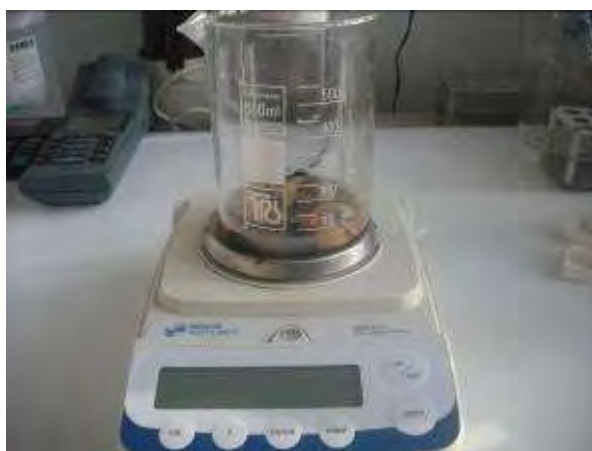
Εικόνα 24 : Ζύγιση σάρκας μυδιών σε ηλεκτρονικό ζυγό ακριβείας.
