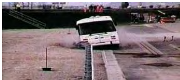
Δοκιμή πρόσκρουσης λεωφορείου σε μεταλλικό στηθαίο ασφαλείας
