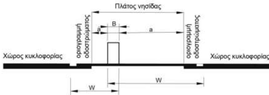
Αμφίπλευρο μόνιμο στηθαίο ασφαλείας που τοποθετείται στο μέσον της νησίδας
