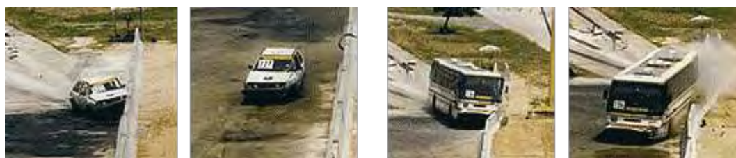
Δοκιμή πρόσκρουσης ΙΧ & λεωφορείου σε στηθαίο ασφαλείας σκυροδέματος
