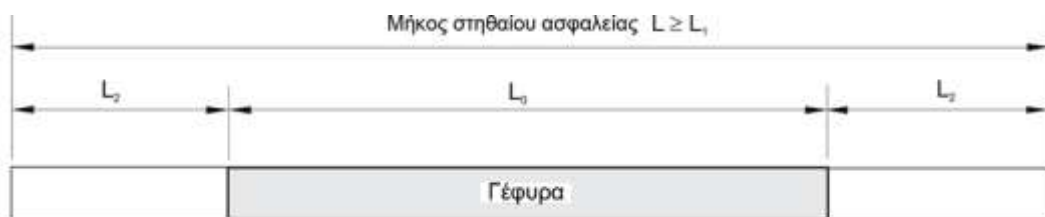
Στηθαία ασφαλείας με κατασκευή σύνδεσης σε γέφυρα
