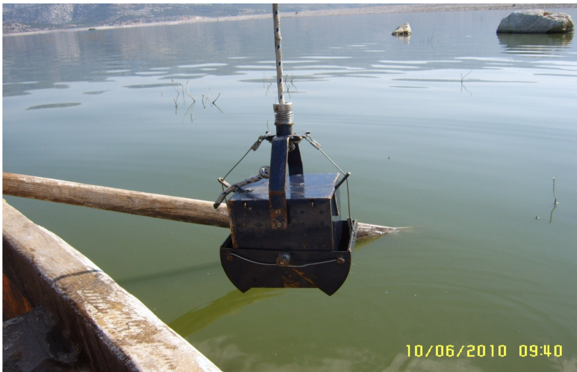
Εικόνες 2.5 και 2.6: Δειγματολήπτης βένθους (Van Veen, Hydro-Bios Apparatebau G.m.b.H Kiel).
