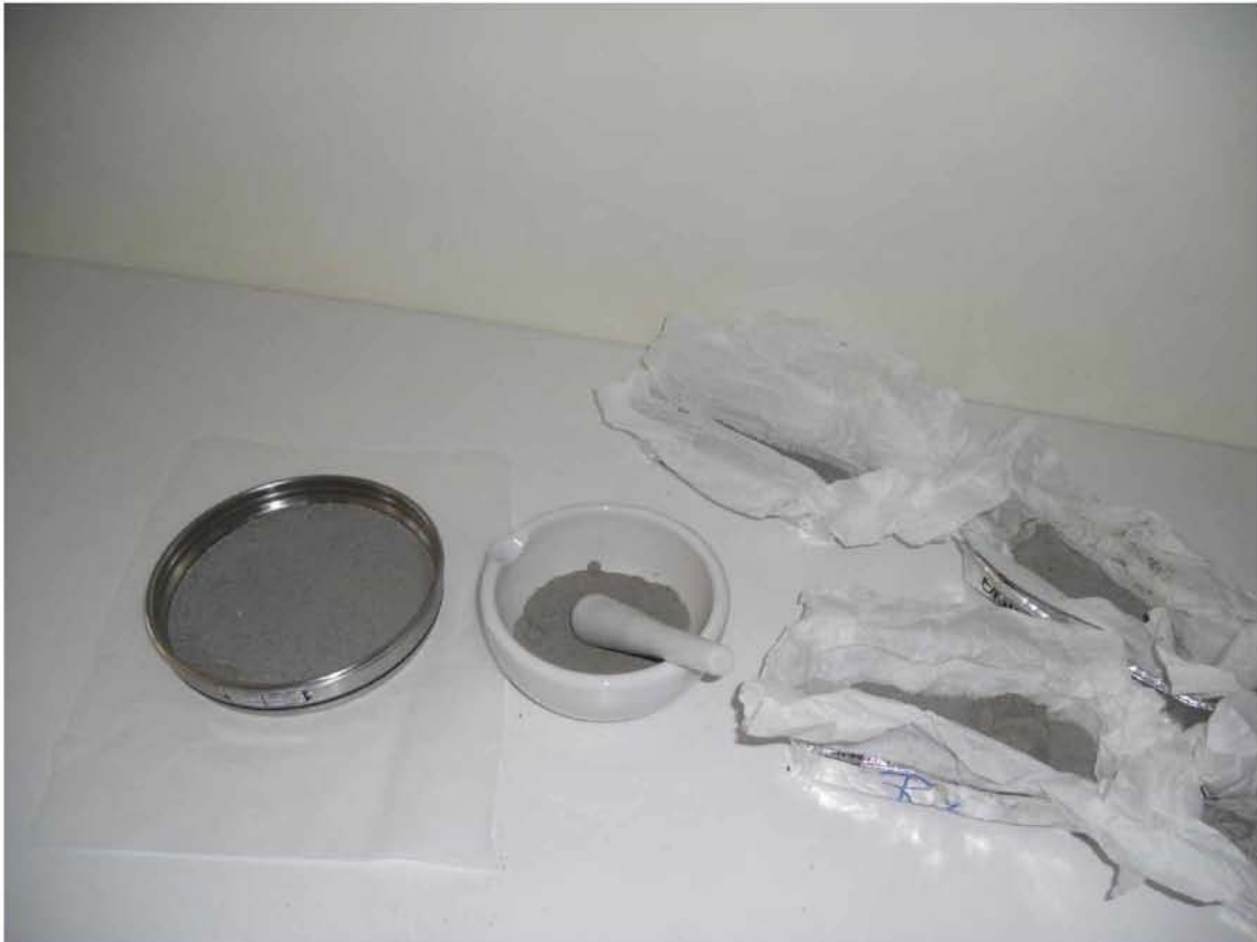
Εικόνα 2.5. Κωνιορτοποίηση και κοσκίνισμα δειγμάτων (16/06/2011).
