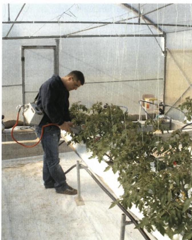
Εικόνα 3.6. Μέτρηση φωτοσύνθεσης σε φυτά τομάτας με τη βοήθεια του συστήματος ADC
