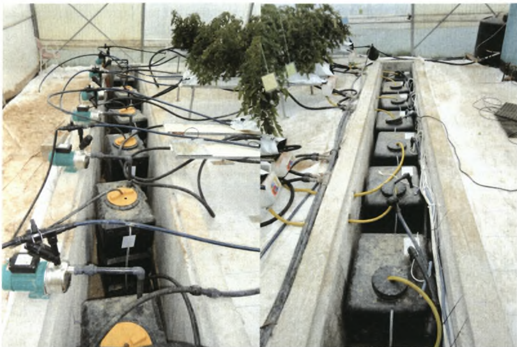
Εικόνα 3.3 Απεικόνιση των δεξαμενών άρδευσης (αριστερά) και των δεξαμενών απορροής (δεξιά).
