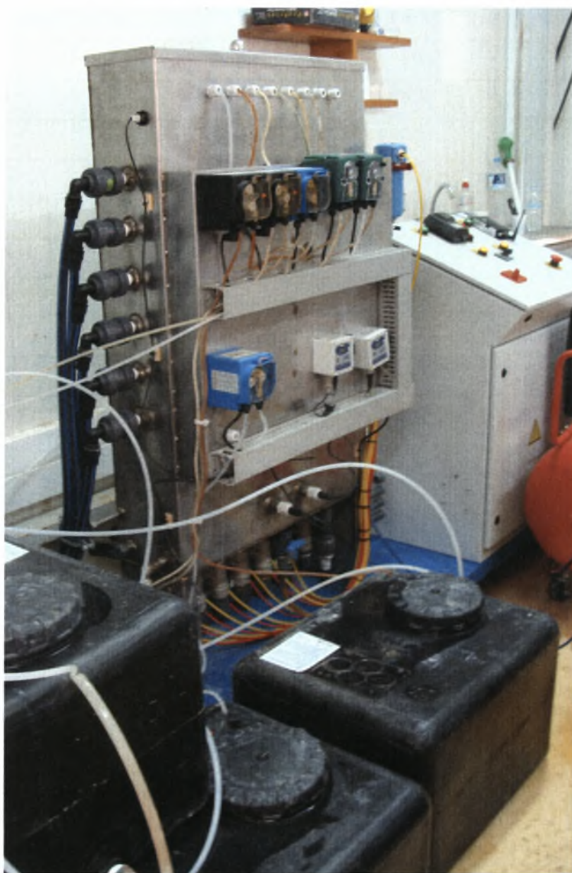
Εικόνα 3.4. Πειραματικό σύστημα παρασκευής - παροχής θρεπτικού διαλύματος.
