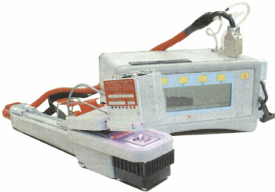
Εικόνα 3.7. Συσκευή μέτρησης φωτοσύνθεσης LCpro+
