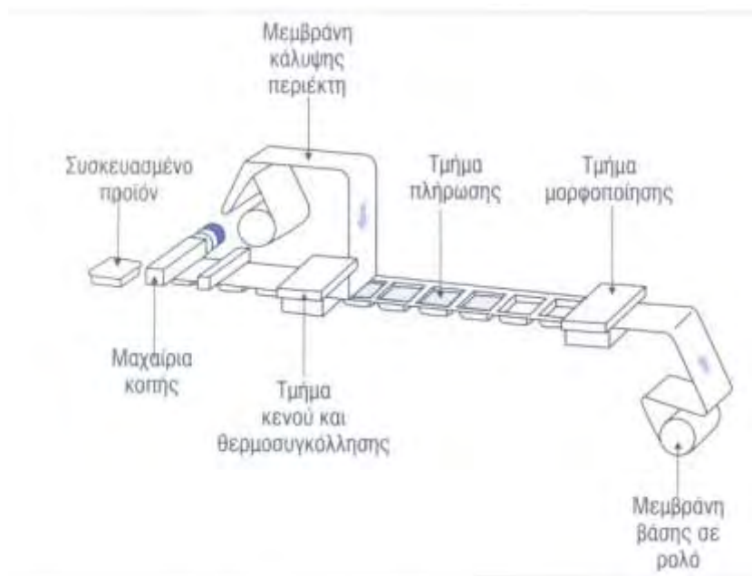
Σχήμα 3.6.1 Σχηματική απεικόνιση συσκευαστικής μηχανής (Μπλούκας, 2004)
