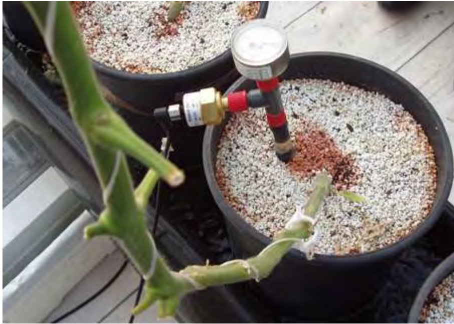
Εικόνα 4 Χρήση τενσιόμετρων συνδεδεμένων σε αυτοματοποιημένο σύστημα για τη διαχείριση υποάρδευσης χρησιμοποιούν σε γλαστρικές καλλιέργειες με υπόστρωμα ελαφρόπετρα και υποάρδευση (POPRURA, 2008)
