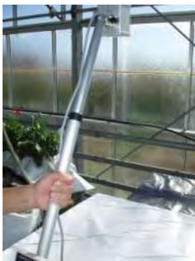
Εικόνα 33 Μετρήσεις ανακλαστικότητας με πολυφασματικό ραδιόμετρο πάνω φυτική επιφάνεια και επιφάνεια αναφοράς (λευκή)
