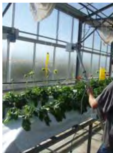
Εικόνα 33 Μετρήσεις ανακλαστικότητας με πολυφασματικό ραδιόμετρο πάνω φυτική επιφάνεια και επιφάνεια αναφοράς (λευκή)
