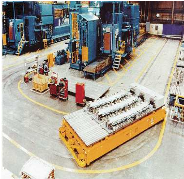
Εικόνα 2: Ρομπότ περιορισμένης κίνησης σταθερής τροχιάς σε χώρο εργασίας (Automatic Guided Vehicles)
