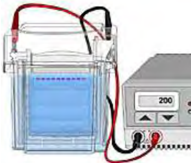
Εικόνα 20: Τυπική συσκευή ηλεκτροφόρησης πηκτώματος πολυακρυλαμίδης
