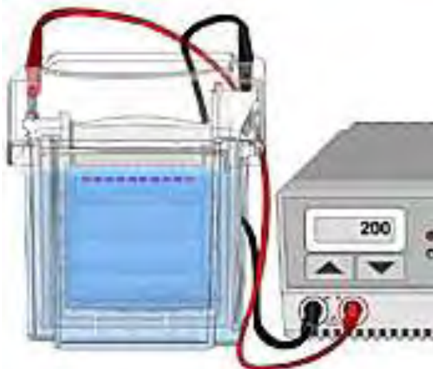
Εικόνα 20: Τυπική συσκευή ηλεκτροφόρησης πηκτώματος πολυακρυλαμίδης
