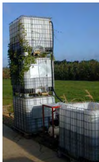
Εικόνα 3.4. Διαγραμματική απεικόνιση του σχεδίου ενός συστήματος βιοφίλτρων τριών δεξαμενών (από De Wilde et al., 2007)
