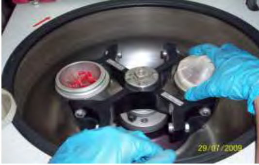
Εικόνα 16: Βήμα 4,6 και 11 (φυγοκέντρηση).
