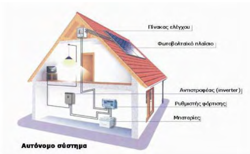
Εικόνα 1.8: Αυτόνομο φωτοβολταϊκό σύστημα.
