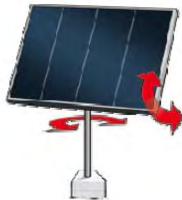
Εικόνα 2.11: Στήριξη με δυνατότητα στροφής του συλλέκτη γύρω από δύο άξονες ( http://www.solar-tracking.com/images/single_axis_icon3.png )
