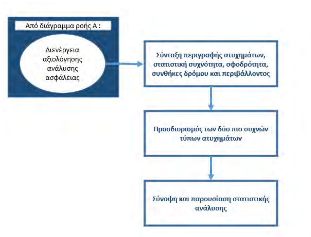
Σχήμα 2. Διάγραμμα Ροής Β - Αξιολόγηση ανάλυσης ασφάλειας
