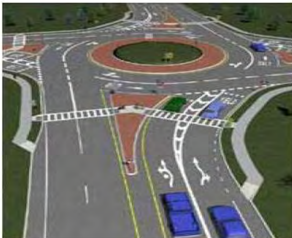
Εικόνα 2.7-1: Παράδειγμα διαμόρφωσης εισόδου για διέλευση μεγάλων φορτηγών
