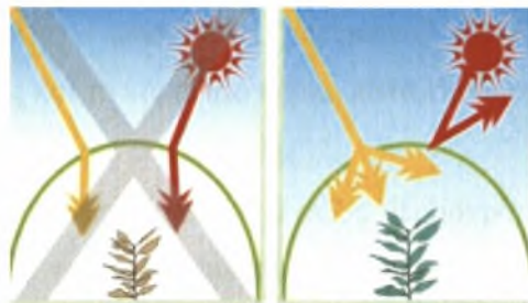
Εικόνα 5: Σχηματική παράσταση της πορείας της ακτινοβολίας σε θερμοκήπιο με ή χωρίς υλικό κάλυψης που απορροφά την κοντινή υπέρυθη ακτινοβολία (NIR)
