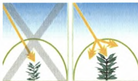
Εικόνα 1: Σχηματική παράσταση της πορείας της ακτινοβολίας, σε θερμοκήπιο με ή χωρίς υλικό κάλυψη που διαχερεί την ακτινοβολία
