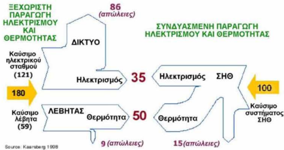
Εικόνα 13 Συμβατικό ενεργειακό σύστημα σε σύγκριση με σύστημα συμπαραγωγής Πηγή: ΚΑΠΕ
