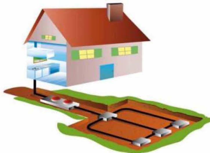
Εικόνα 11 Σύστημα οριζόντιου εναλλάκτη σε έδαφος (Πηγή: Μπινιάρης, 2012)
