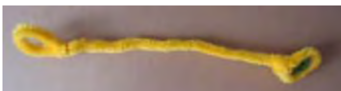
Εικόνα 4: Με τα δαχτυλίδια-λαβές τεντωμένα (αντιπαραβολή με το κίτρινο στην εικόνα 2), το μήκος των Ίντσών «μεγάλων», επηρεάζοντας το αποτέλεσμα της μέτρησης. Το λάθος αυτό στη χρήση παρατηρήθηκε μόνο στα χειραπτικά Ίντσες.
